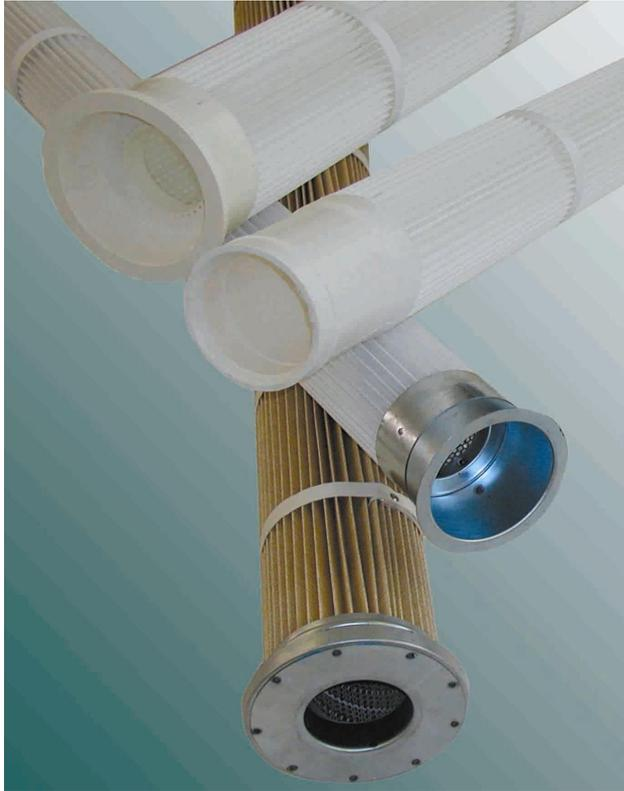
Ziel soll es sein, die Anlage nicht baulich verändern zu müssen und dennoch den gestiegenen Anforderungen zu entsprechen. Als Ersatz für die bisher verwendeten Filterschläuche stehen weitaus effektivere und vor allem platzsparendere Filterpatronen mit der Bezeichnung **ULTRASEP** zur Verfügung. Auf gleichem Raum findet dank dieser Patronen die nahezu dreifache Filterfläche Platz.
