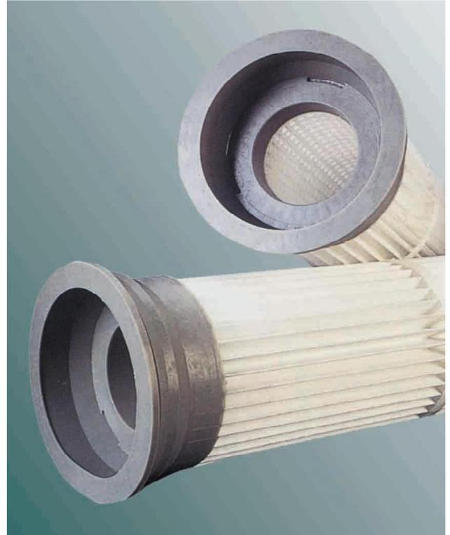
**ULTRASEP** Filterpatronen mit einem 100%-igen Polyester-Spinnvlies verhindern dank offener Faltengeometrie und flacher Faltentiefe das Eindringen von Partikeln und tragen so zu einer deutlichen Steigerung der Abscheideleistung (BIA-Klasse C, d.h. Durchlassgrad <0,1%) bei dauerhaft niedrigen Differenzdrücken bei. Spinnvliese unterscheiden sich von Nadelfilzen durch eine sehr feine Porenstruktur und einen formstabilen Aufbau.
